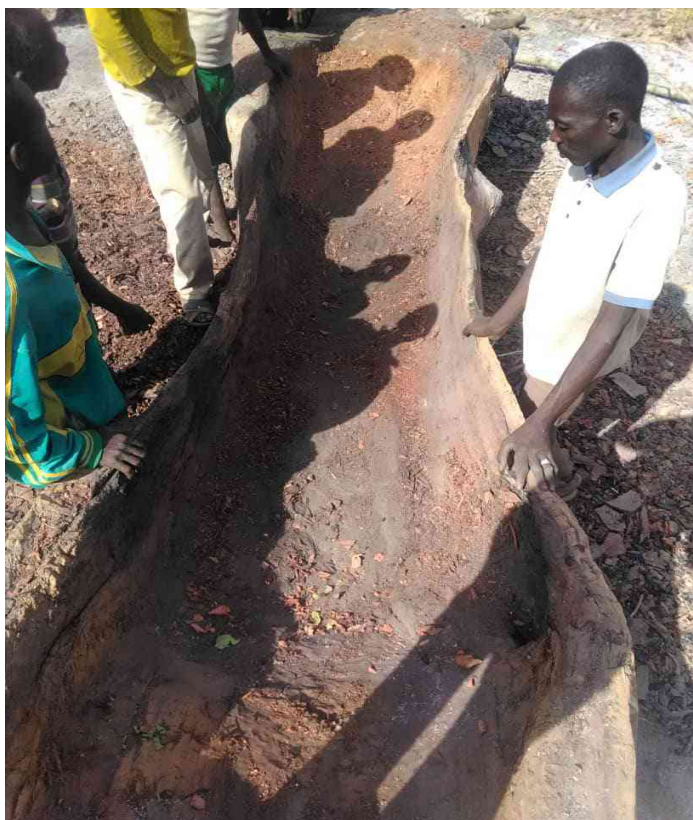
Piroga se vyrábí výhradně za pomoci ručních nástrojů a ohně. Výsledek bude hotový v řádu několika týdnů. Pro spuštění na vodu bude zapotřebí sílu terénního vozidla.
