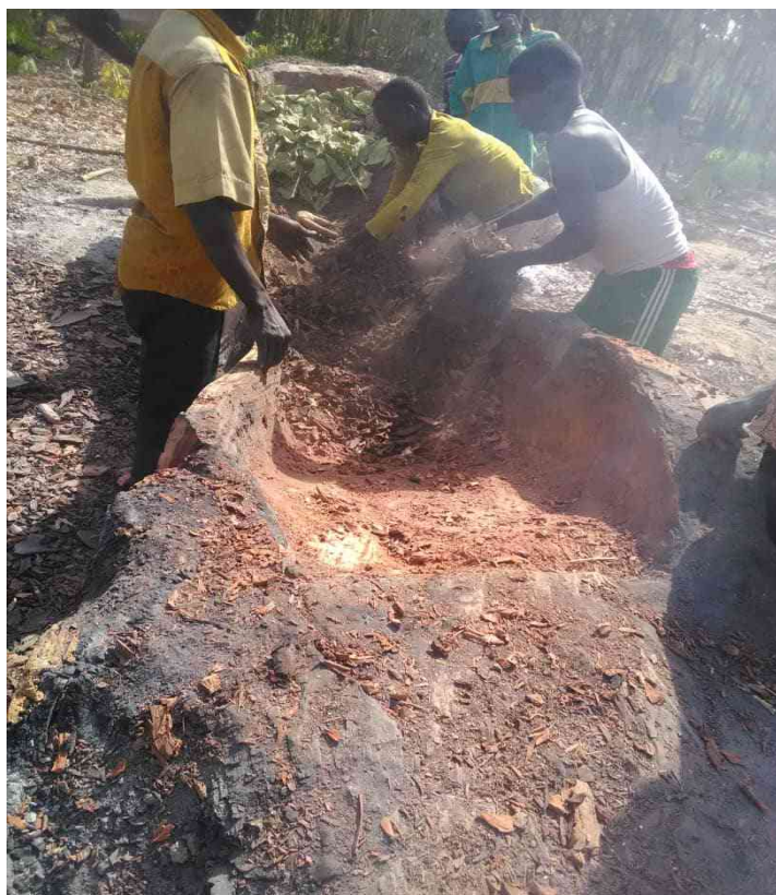
Piroga se vyrábí výhradně za pomoci ručních nástrojů a ohně. Výsledek bude hotový v řádu několika týdnů. Pro spuštění na vodu bude zapotřebí sílu terénního vozidla.
